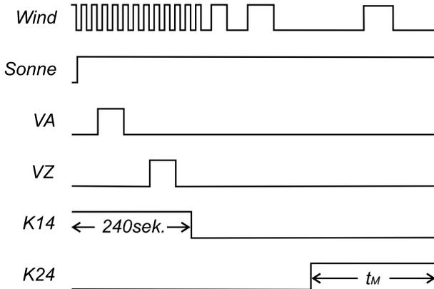
Eine Umschaltpause von  $t_{uv}=0.6s$  beim Umschalten zwischen K14 und K24 dient dem Motorschutz der Markise:
