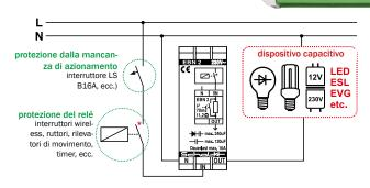
Il carico capacitivo di lampade a LED, lampade fluorescenti, lampade a risparmio energetico e gli ulteriori moderni apparecchi elettrici causa picchi di corrente fino a oltre 100 A! Questo può causare la fusione dei contatti del relè.
